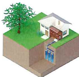
Pompe à chaleur sur corbeilles géothermiques
