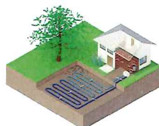
Pompe à chaleur sur capteurs enterrés horizontaux
